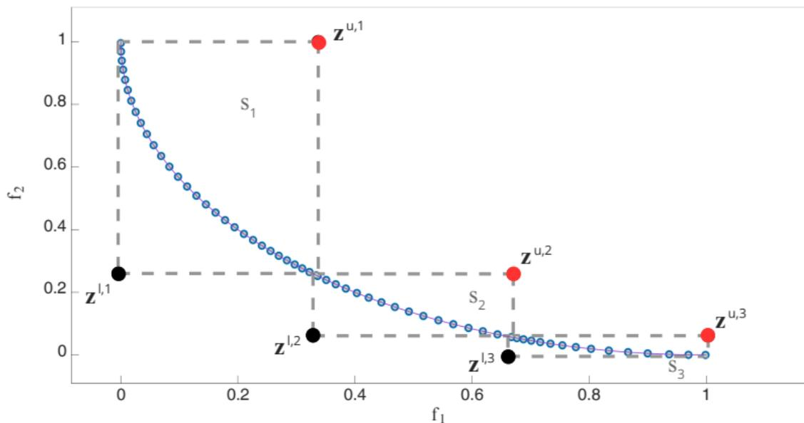
**Figura:** Aproximación de POF del problema IDTLZ2 aplicando AS-MOEA NSGAIII con  $N = 60$  tras 375 generaciones (250 aplicando Fase 1 y 125 aplicando Fase 2).
